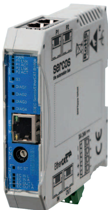
Il bridge Sercos/Ethercat consente di far interagire due interfacce di comunicazione fra le più diffuse sul mercato
