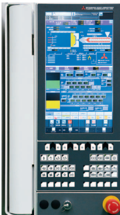
Il controllore installato nella serie MEIII: Panel PC Beckhoff CP6216
