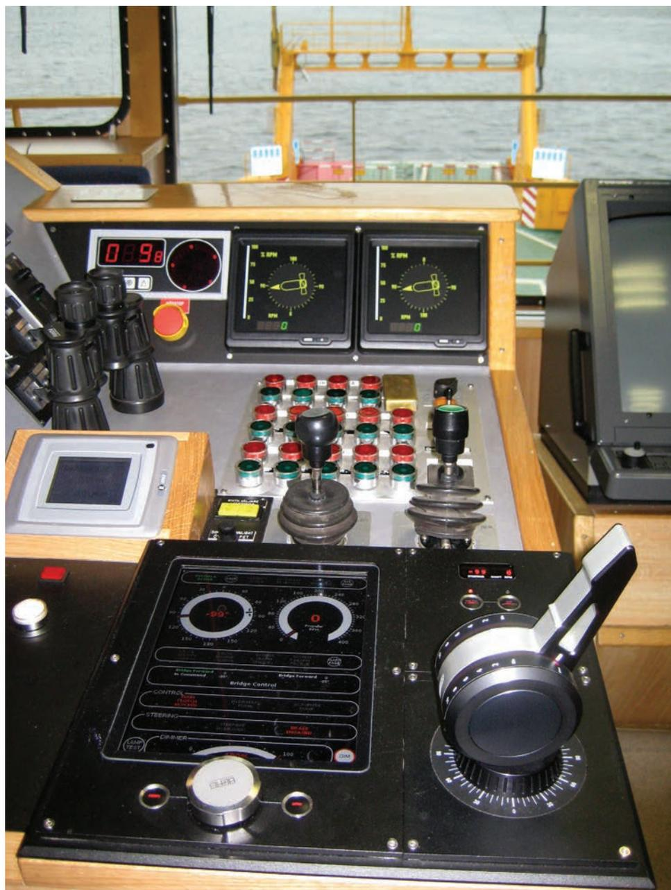
**Display per il monitoraggio dell'elica dell'imbarcazione**
