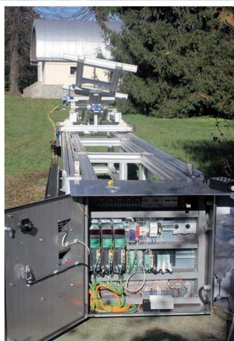
based, che coordina via Ethernet e tramite protocollo Modbus TCP/IP tre servomotori Digitax (ST 1401 - 1404 Plus STD) e servomotori Unimotor fm con encoder assoluto da 3,1 a 9,4 Nm (modelli 075U2C300BAECA075140 e 115U2C300BAECA115190) di Emerson, con I/O remotati di un altro costruttore. Il coordinamento delle movimentazioni e lo sviluppo degli algoritmi necessari a
