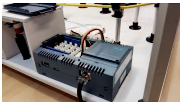
Il gateway Simatic con a bordo le schede per il controllo di movimento, che con Arduino sono chiamate 'shield'
