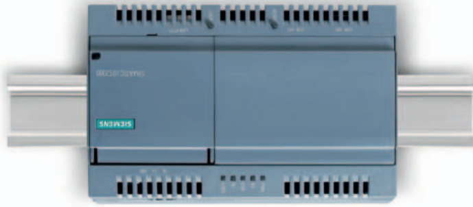
Il gateway Simatic, basato sull'architettura Arduino, può essere montato su guida Din ed è pienamente rispondente agli standard industriali
