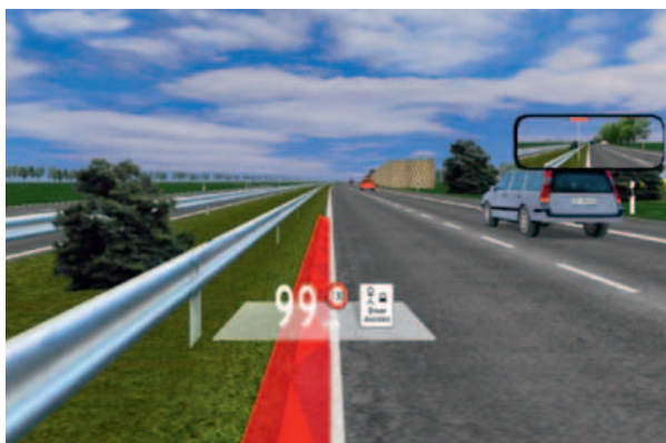
Con Ansys Scade e Ansys Scade Display è stato sviluppato l'HMI usato nella simulazione
