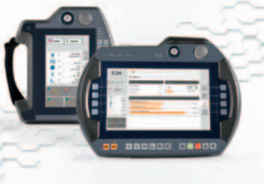
L'interfaccia Mobile Panel 7100 di B&R offre una combinazione di touch screen integrato e di tasti funzione dedicati
