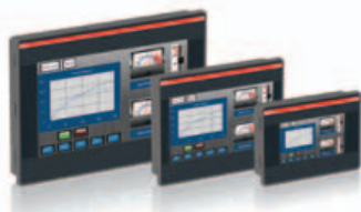
I pannelli di controllo CP600-eCo di ABB sono dotati di uno schermo luminoso ad alta risoluzione nelle taglie 4.3, 7 e 10.1 pollici
