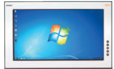
La protezione IP 65 e la robustezza rendono i Polaris PC Bartec adatti ad ambienti gravosi e per installazioni all'aperto
