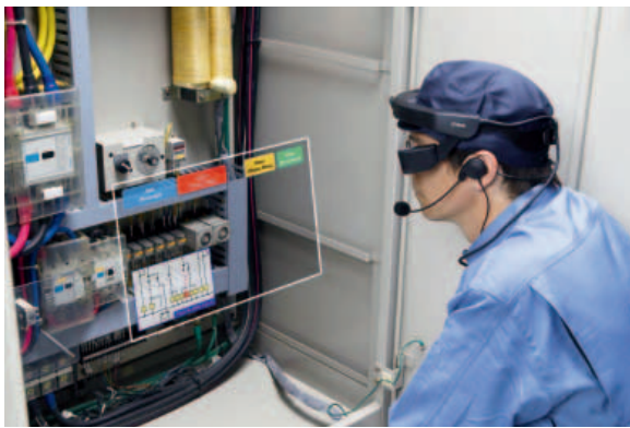
Figura 1 - Smart Glass per analisi guasti, tutoring, manutenzione programmata (Epson)
