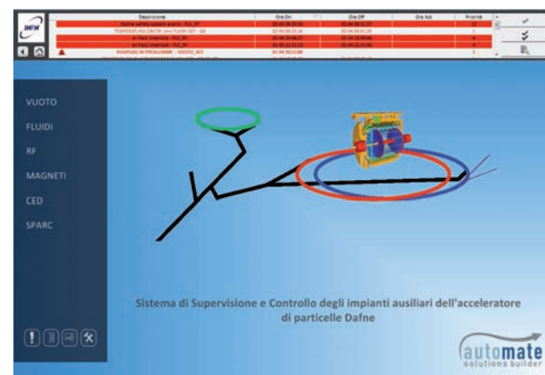
Il sinottico del sistema di controllo degli impianti ausiliari di Dafne
