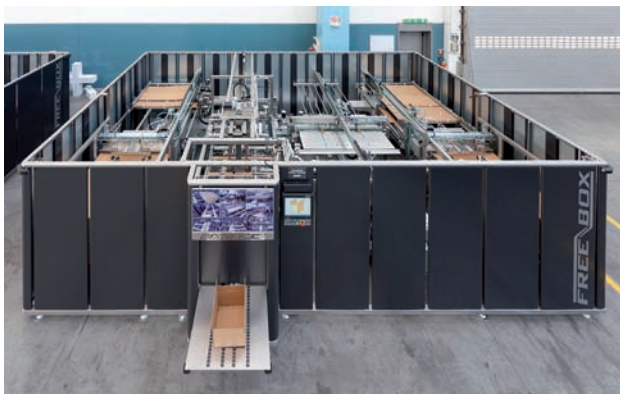
Freebox è un sistema completo e compatto che permette di creare scatole di cartone per imballaggio in tempo reale
