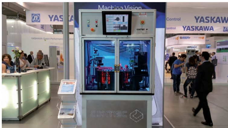
Una macchina Cosmec per i test fine linea con automazione National Instruments
