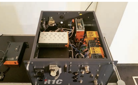
Il controller R1C in versione per rack da 19" con componentistica B&R
