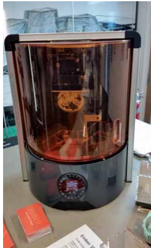
La nuova stampante Ember 3D di Autodesk è basata sulla stereolitografia: utilizza un polimero liquido che solidifica se esposto alla luce di una particolare lunghezza d'onda
