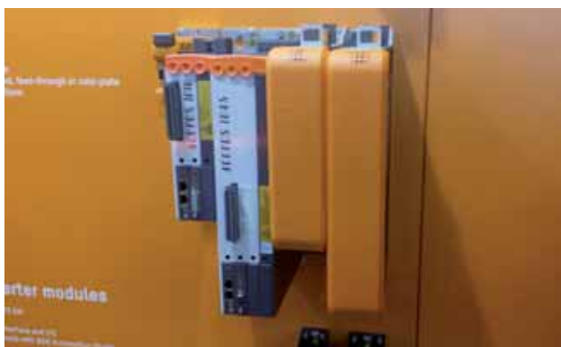
I nuovi Acopos P3 offrono una densità di potenza di 4 A per litro
