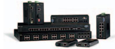
*Gli switch EtherWan, disponibili in varie versioni con differenti numero di porte, range di temperatura operativa, tecnologia trasmissiva (Rame o Fibra Ottica), SFP o porte ottiche fisse*
