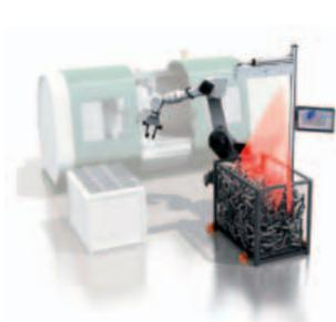
**Il sistema PLB di Sick per effettuare il picking da un contenitore di parti sfuse usa la telecamera 3D ScanningRuler**
