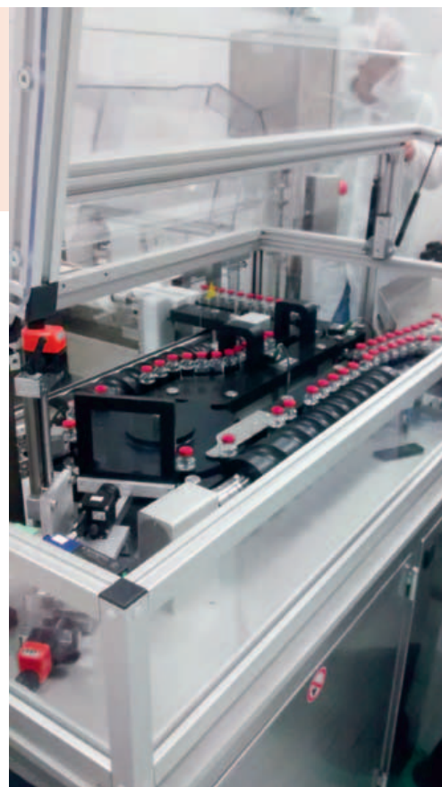
L'impianto per l'inserimento di tappi sui flaconi di vetro consente la stampa di dati variabili grazie al supervisore Movicon di Progea
