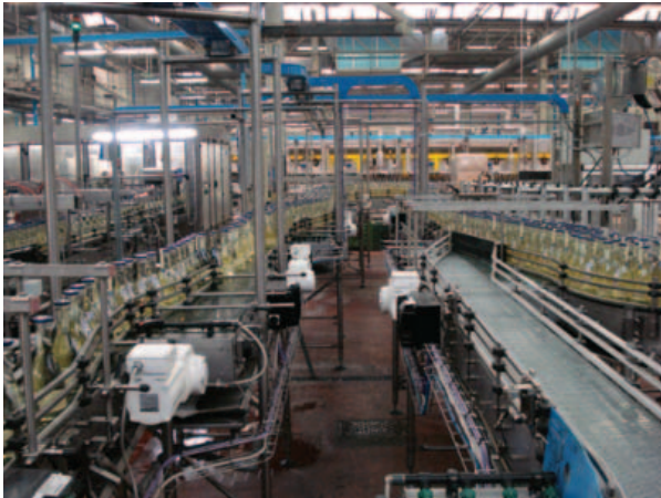
La linea di imbottigliamento del vino realizzata con tecnologia di movimento Danfoss
