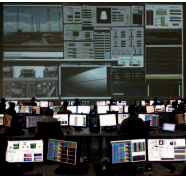
Su molti dei monitor della sala di controllo di SpaceX è visibile l'interfaccia grafica del software NI LabView (fonte: Elon Musk)
