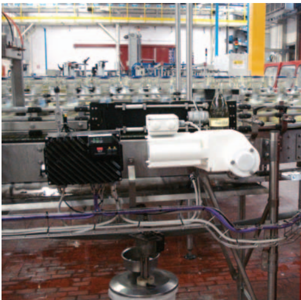
Per realizzare i nastri trasportatori sono stati utilizzati azionamenti, inverter ad alte prestazioni e motoriduttori igienici di Danfoss
