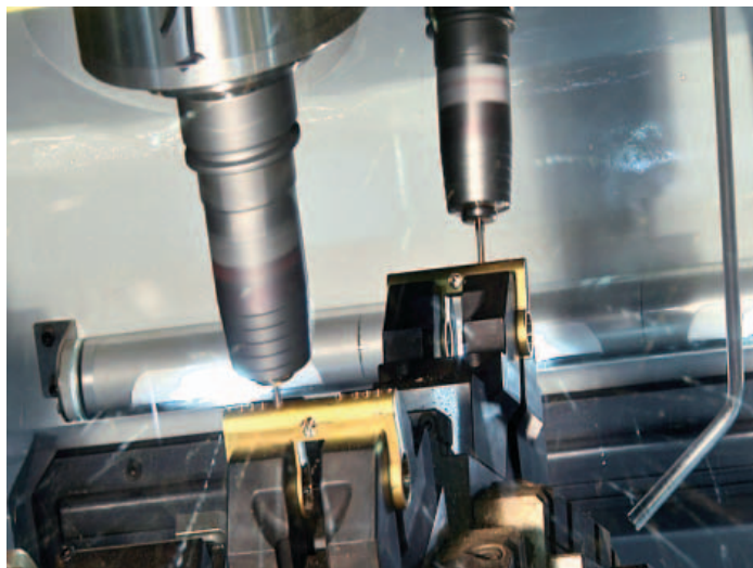
Ogni stazione di lavorazione di una macchina transfer costituisce, in pratica, una macchina utensile speciale
