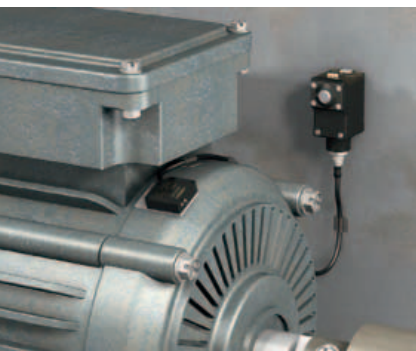
Il sensore di vibrazione e temperatura QM42VT di Turck Banner abbinato a un nodo wireless Q45VT consente il monitoraggio remoto dello stato della macchina
