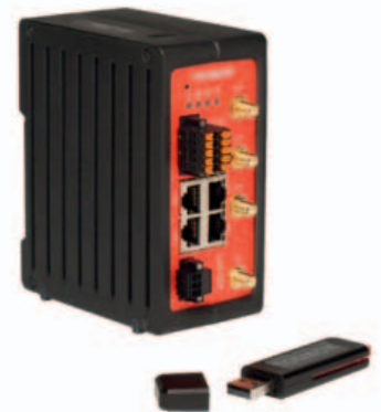
Tosibox Lock 500 ha un throughput VPN crittografato fino a 90 Mbit/s, un modem LTE integrato e I/O digitali
