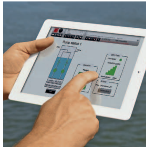
Con un sistema di supervisione basato su protocollo HTTP o HTTPS si possono utilizzare dei browser standard e la visualizzazione può essere realizzata su differenti tipologie di dispositivi, in base all'applicazione
