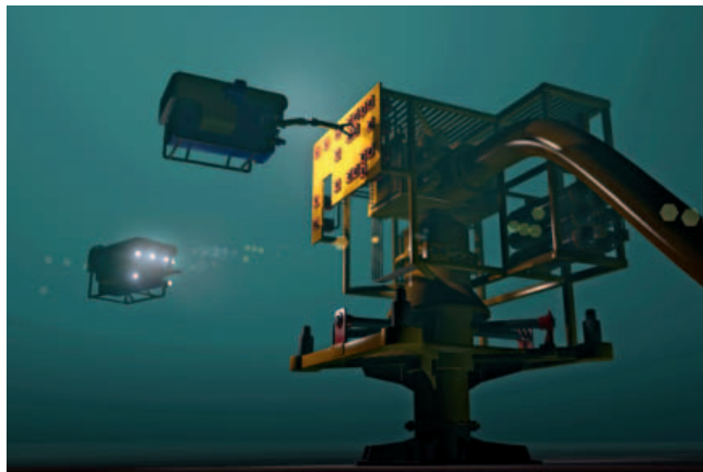
Alcuni Rov eseguono mansioni di precisione come il montaggio e lo smontaggio di componenti e l'apertura e la chiusura di valvole
