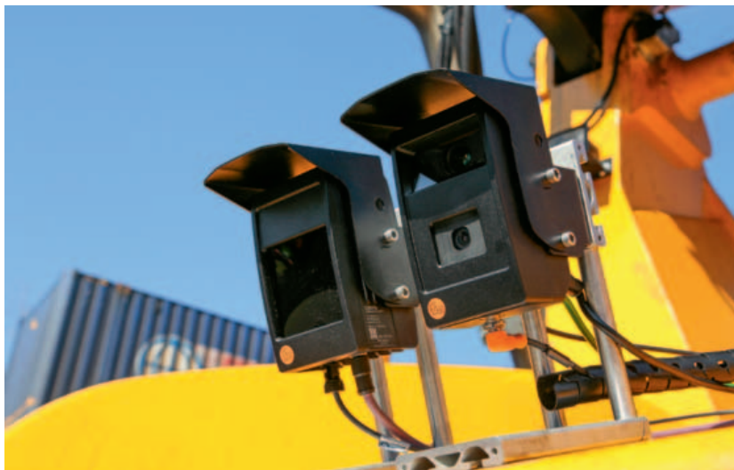
Sistema di anticollisione automatico: la telecamera 3D sul retro avverte immediatamente in caso di ostacoli e possibili collisioni
