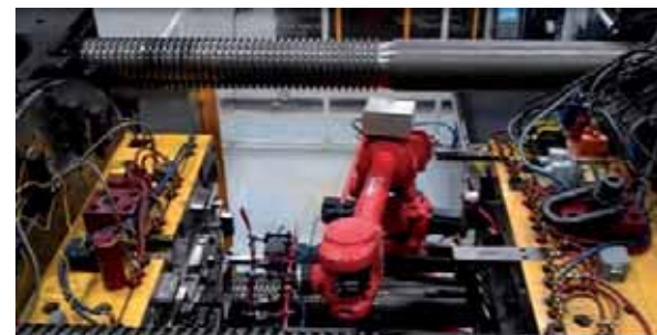
Dettaglio del robot in fase di scarico del pezzo dalla pressa
