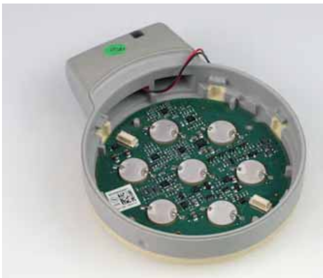
Figura 3 - Parte interna del trasduttore a ultrasuoni. Sette identici elementi piezo sono disposti simmetricamente e operano sia come trasmettitori che come ricevitori di ultrasuoni (Immagine: Philips)
