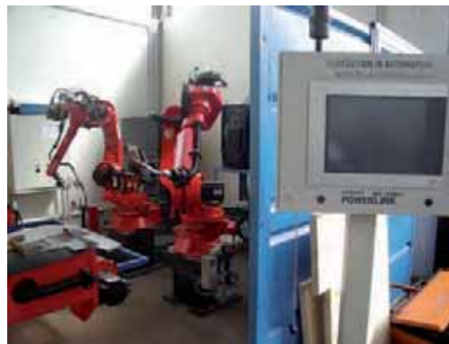
La cella è un sistema integrato, senza PLC, gestita da un pannello touch
