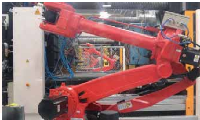
Linea di asservimento presse di stampaggio della plastica realizzata da Mgm Robotics
