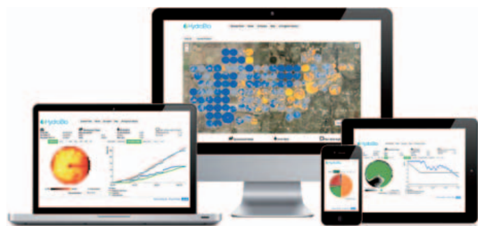
^ Il software di Hydrobio elabora dati provenienti da immagini satellitari, dati meteo e dati sui volumi di irrigazione
