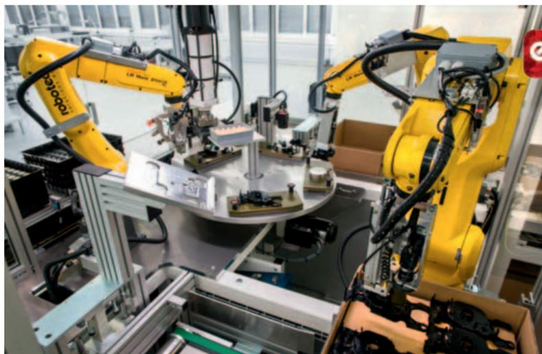
**Il sistema Fanuc iRVision integrato consente al robot di riconoscere lo strato e la posizione degli elementi da assemblare**
