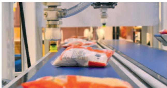
3D un robot può prelevare gli oggetti rapidamente e in sicurezza senza entrare in collisione con loro. Questo non solo aumenta l'efficienza, ma riduce anche il rischio di danneggiamenti. Inoltre, questa tecnologia offre maggiori possibilità per l'ispezione del volume e del peso e il rilevamento di anomalie nella forma dell'oggetto.
