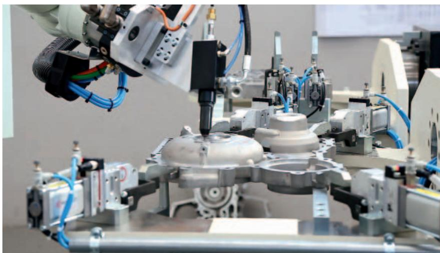
**Il robot RS80 può prelevare una pistola per la gestione dei rivetti a strappo e procedere all'inserimento degli stessi nei fori, dove è richiesta una capacità di posizionamento di meno di un decimo di mm**
