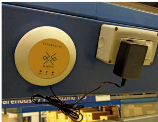
**L'EchoBeacon opera per identificare l'asset all'interno di una precisa area e per tracciarne la movimentazione**
