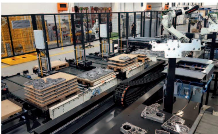
**I pallet portapezzi scorrono su rulliere motorizzate dove i pezzi stessi sono disposti a più strati divisi da separatori, tali da garantire l'autonomia richiesta**
