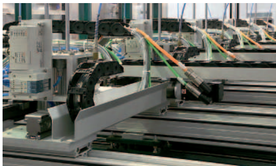
Per rimuovere le bottiglie errate e inserire quelle corrette ciascuna delle due pinze viene movimentata dagli attuatori lineari a cinghia di Parker
