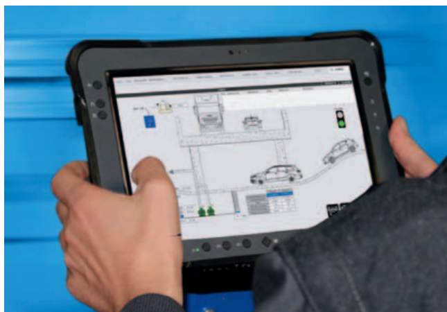
Sinottico di monitoraggio del sottopasso realizzato tramite Scada
