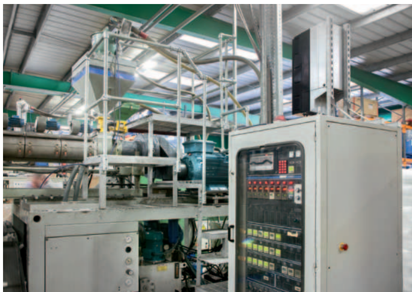
PrimePac ha deciso di sostituire il vecchio motore idraulico utilizzato per azionare un estrusore su una soffiatrice
