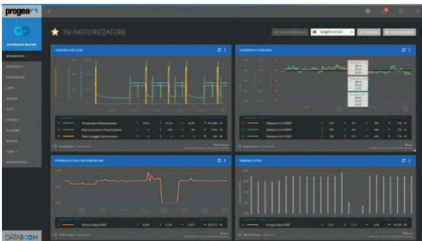
L'impianto è gestito da uno Scada che attraverso i driver Databoom di Progea invia dati di produzione verso Progea Cloud.Databoom
