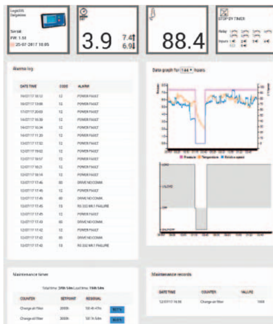
Figura 4 - Stato del singolo compressore
