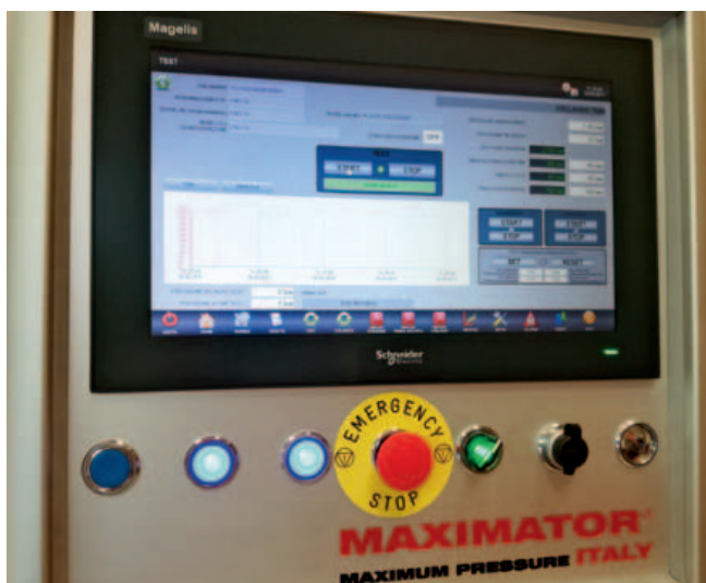
Quadro di comando con iPC Magelis e pulsantiera a filo pannello
