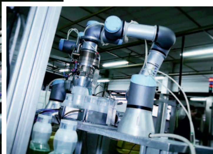
Un dettaglio dell'utensile di serraggio applicato alla flangia del robot UR3
