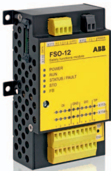
Il modulo opzionale FSO-12 per funzioni di sicurezza viene installato e cablato all'interno dell'azionamento per implementare diverse funzioni e diagnosi di sicurezza in un modulo compatto e affidabile
