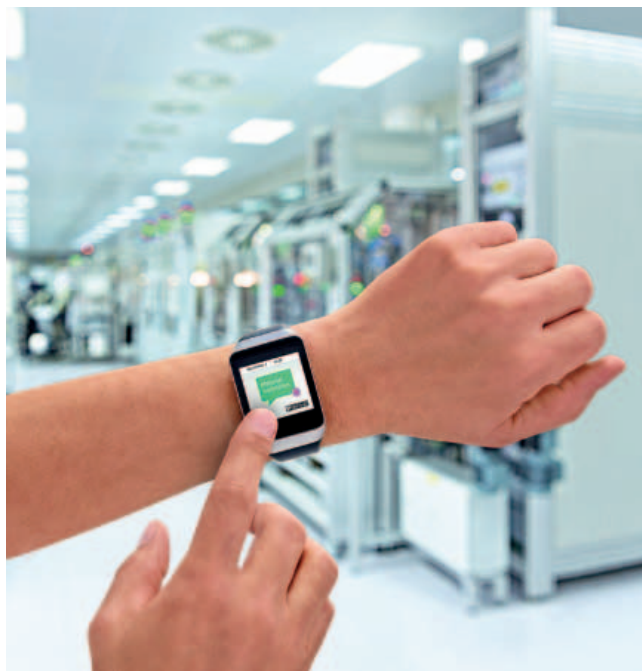
Messaggi di stato e allarmi vengono inviati direttamente a uno smartwatch indossato al polso dall'utente
