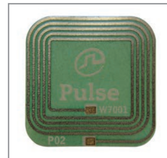
Figura 2 - L'antenna NFC di Pulse Electronics W7001 è economica, sottile e flessibile
