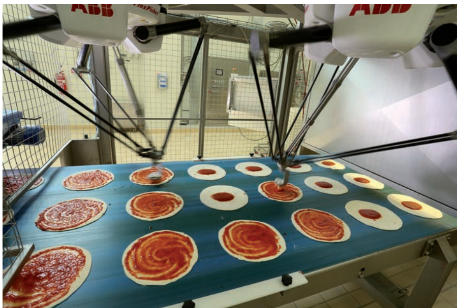
I robot effettuano l'operazione con un movimento a spirale a partire dal centro
