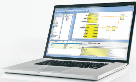
Programmazione integrata dei moduli di sicurezza
