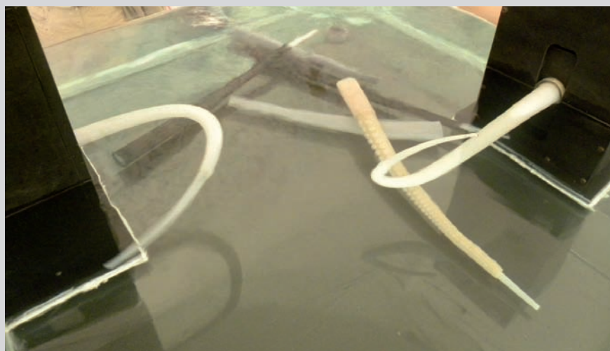
I tentacoli del polpo robot della Scuola Superiore Sant'Anna di Pisa sono realizzati in materiale 'soft'
