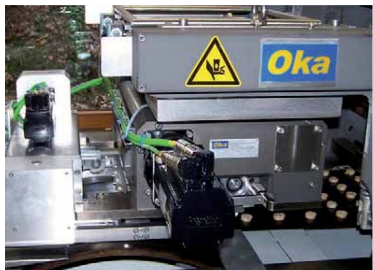
Dolci tagliati a filo sul nastro trasportatore di alluminio: si riconoscono dal cablaggio di colore verde due dei quattro servomotori SH
