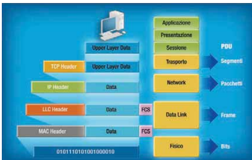
Figura 2 - Architettura del modello di riferimento ISO-OSI: caso di incapsulamento/trasmissione
