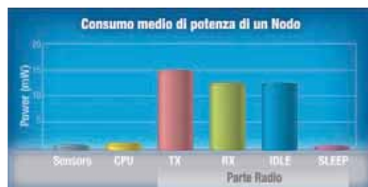
Figura 1 - Indicazione generale della potenza necessaria alle varie parti componenti un nodo wireless
