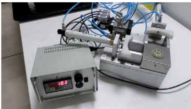
L'indicatore per celle di carico PS30 verifica a inizio ciclo la presenza del cuscinetto
