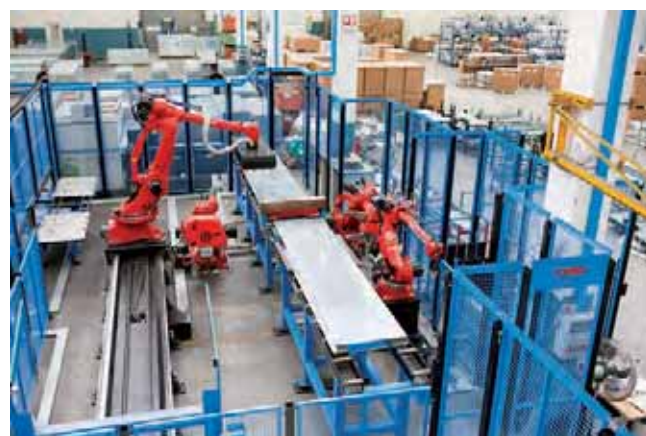
Il Comau Smart NJ 290 trasla per posizionare i cassetti
