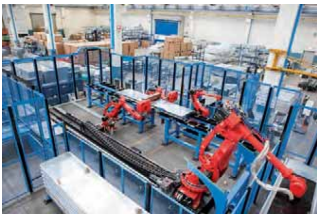
La cella installata da SIR in System, automatizzata con 4 robot Comau
