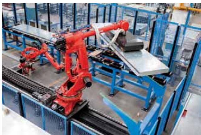
Comau Smart NJ290 effettua il caricamento di un nuovo cassetto
