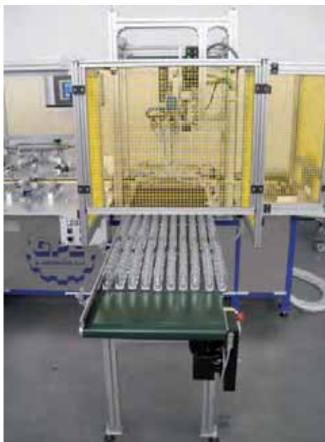
La soluzione comprende: software SoMachine Motion, motori SH3, modulo di azionamento Lexium62
