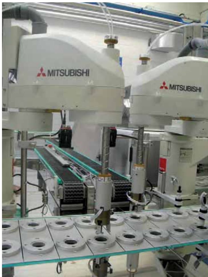
I sei robot a bordo della linea di assemblaggio, tutte unità stand alone, sono di Mitsubishi Electric
