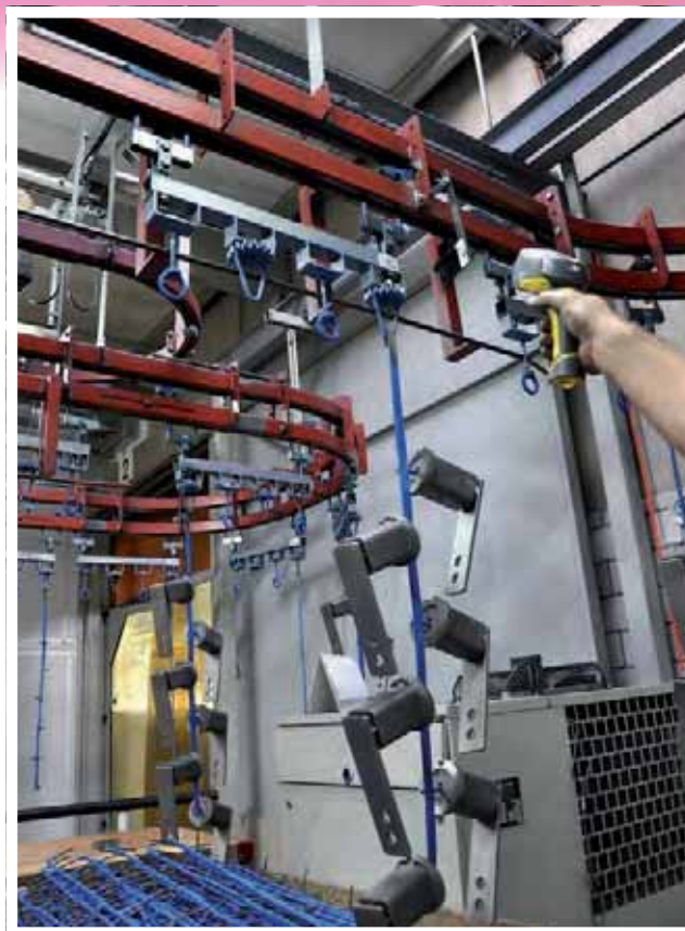
I codici 2D dei carrelli sospesi vengono letti dal DataMan 8100 con rapidità e affidabilità anche a una distanza di circa un metro
