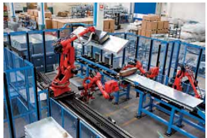
Una fase di approntamento lavoro della cella di saldatura cassette automatizzata con robot Comau
