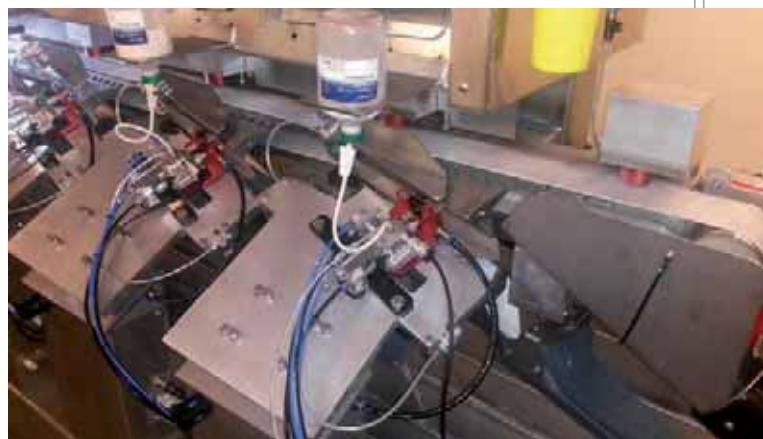
In base alla profondità e posizione di iniezione, calcolate singolarmente, i motori LinMot posizionano in modo preciso ogni stazione di vaccinazione
