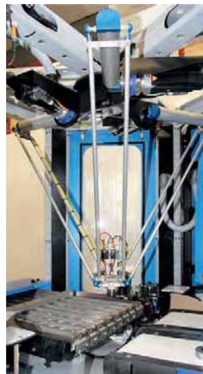
Control e Drive Technology di Beckhoff, dal Panel PC CP6203 attraverso i servomotori AM30xx, consente il controllo dinamico del delta robot e sequenze di test rapide e precise
