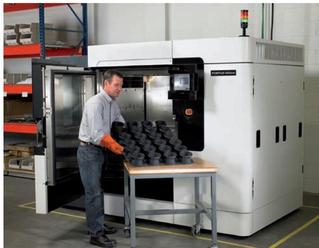
**Produzione in serie di pezzi in materiale termoplastico con una stampante in tecnologia FDM di Stratasys**
