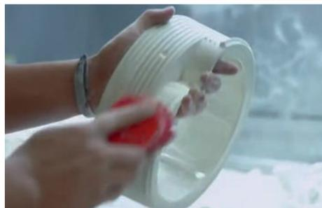
**Ripulitura di un pezzo appena stampato mediante sinterizzazione laser selettiva (SLS)**
