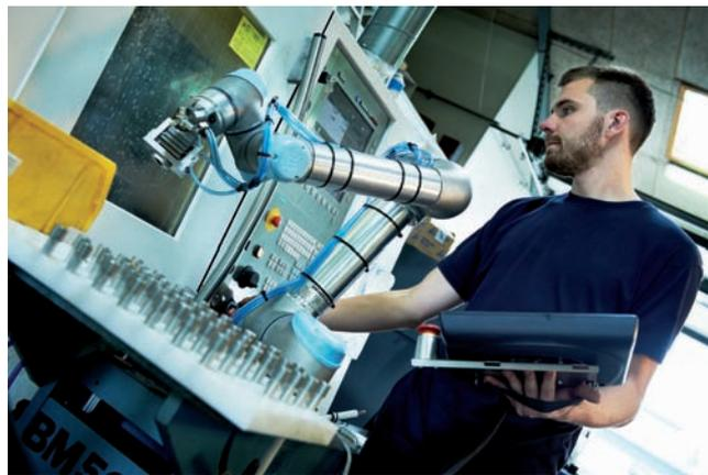
**I robot permettono a un addetto di operare su una cella con otto macchine CNC in funzione simultaneamente**
