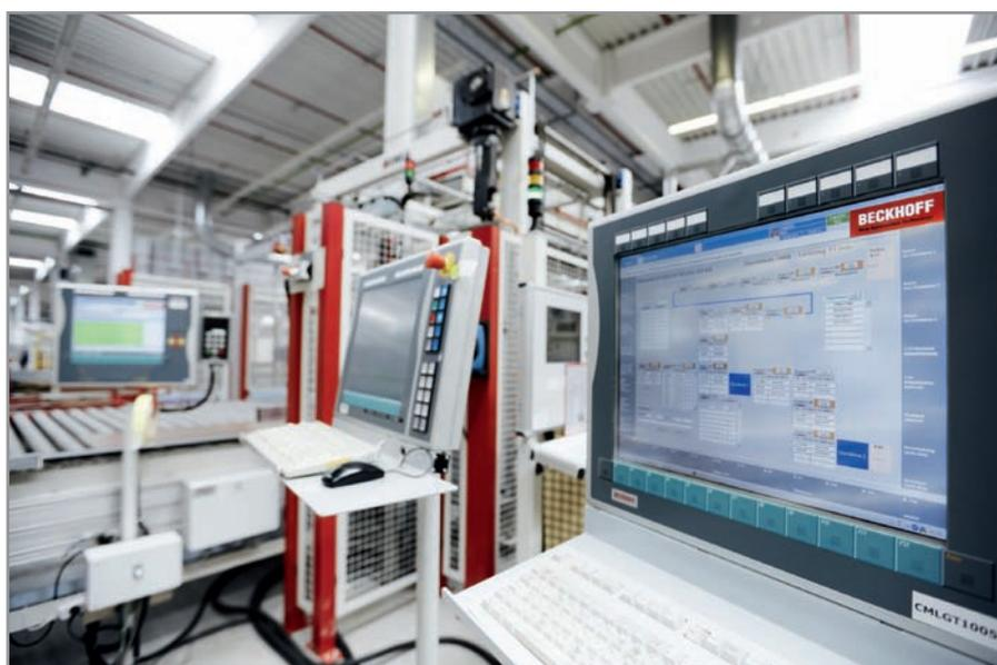
**Durante l'intero processo di produzione tutte le informazioni relative alla macchina e allo stato di produzione possono essere recuperate tramite i Control Panel e i Panel PC di Beckhoff**
