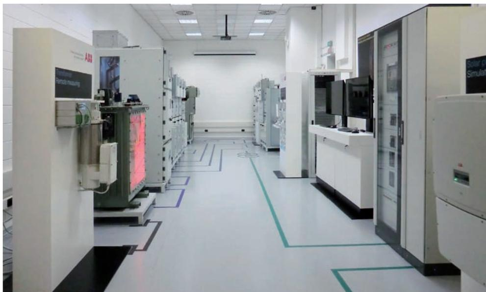
**Nello 'Smart Lab' ABB di Dalmine viene simulata una rete di distribuzione dell'energia elettrica di media tensione in configurazione 'magliata'**
