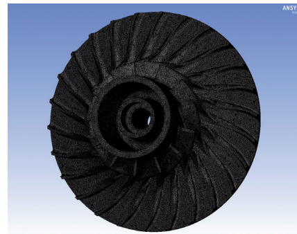
Modello di simmetria ciclica di un girante radiale
