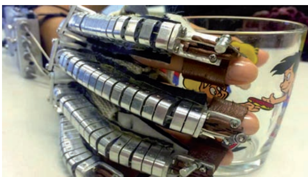
Il guanto indossabile FEX (Finger Extending Exoskeleton) si è dimostrato utile per la riabilitazione di pazienti colpiti da ictus
