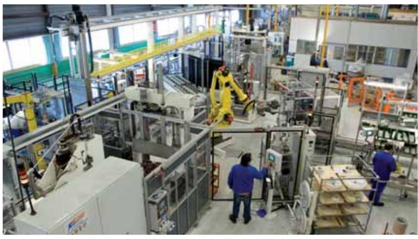
**A Mansle si producono motori di grandi dimensioni con l'impiego di robot e varie macchine anche come ausilio nello spostamento dei pezzi**
