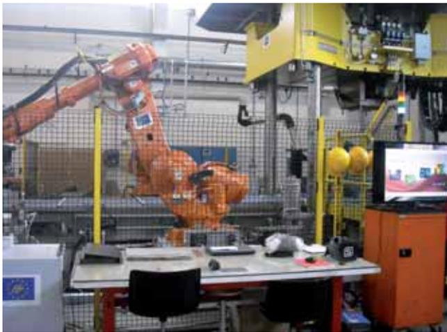
**I due robot antropomorfi a sei assi di ABB integrati movimentano i pezzi nella pressa e le teste di miscelazione**
