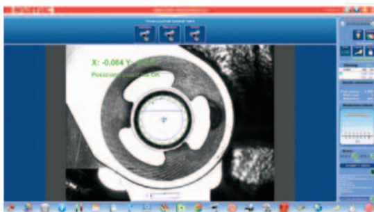
Auto-settaggio dispositivo a seguito di verifica con sistema di visione.
