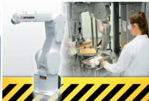
La soluzione Mitsubishi Electric avvicina i robot standard alla collaborazione creando differenti aree di lavoro a velocità norme diverse.
