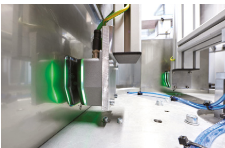
Gli accoppiatori NearFi trasmettono energia e dati Ethernet in tempo reale senza contatto, anche in applicazioni rotanti, senza necessità di un centraggio preciso
