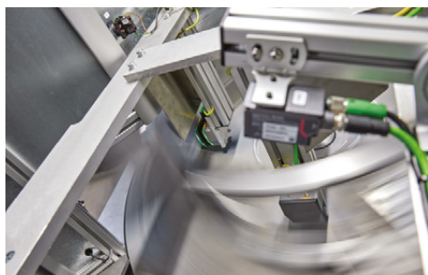
Accoppiatore NearFi in uso in una saldatrice laser
