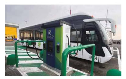
Enerhub ha implementato un'infrastruttura di ricarica per i mezzi speciali elettrici utilizzati nell'area aeroportuale (Airside), inclusa una stazione Fast da 240 kW in c.c.
