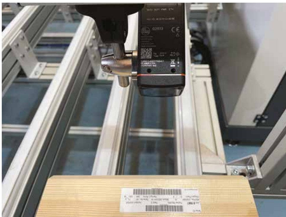
La torretta emette una segnalazione luminosa e acustica quando il barcode del pezzo viene letto e riconosciuto
