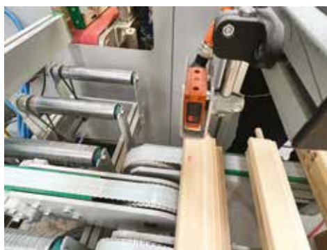
All'interno della linea sono inserite numerose fotocellule O5D100 di ifm
