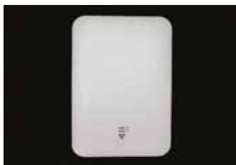
Per gestire le due celle frigorifere sono stati installati gli access point Cambium Networks cnPilot E501, capaci di resistere alle basse temperature
