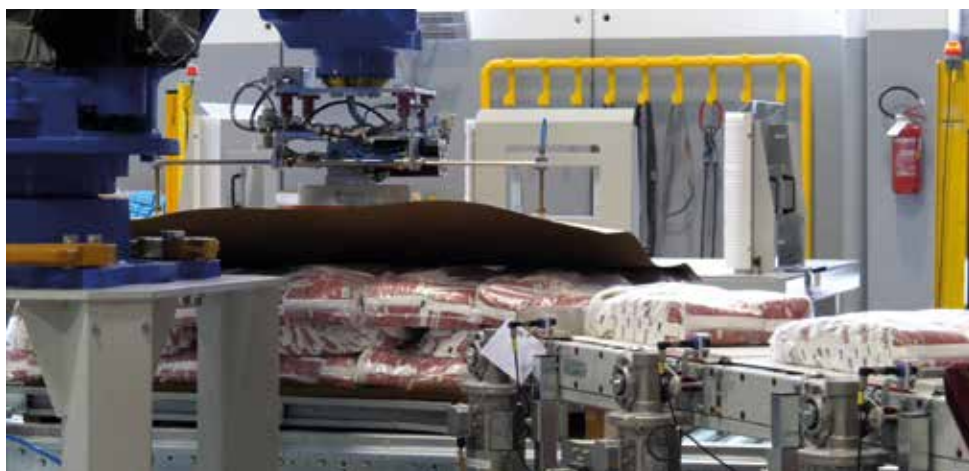
Recentemente Ocrim ha realizzato un sistema di fine linea per pallettizzazione e avvolgimento con film estensibile
