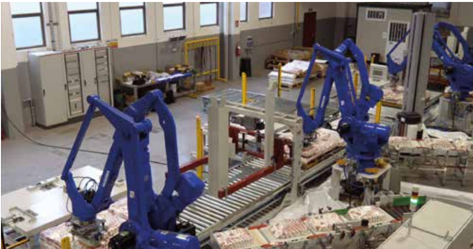
L'isola di lavoro impiega 3 robot Yaskawa Motoman MPL160. Ciascun robot preleva da un nastro a rulli i fardelli da 25 sacchetti di farina da 1 libbra l'uno e li impila su un pallet, alternando gli strati con delle falde interstrato
