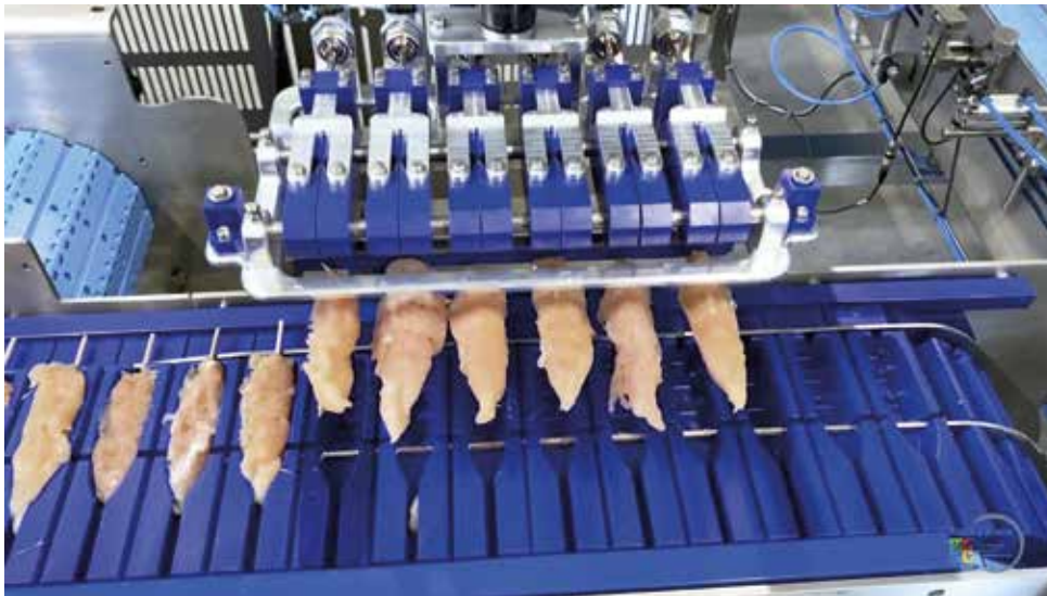
La pinza è realizzata in alluminio anodizzato, mentre tutti gli altri componenti del sistema sono realizzati in acciaio inossidabile
