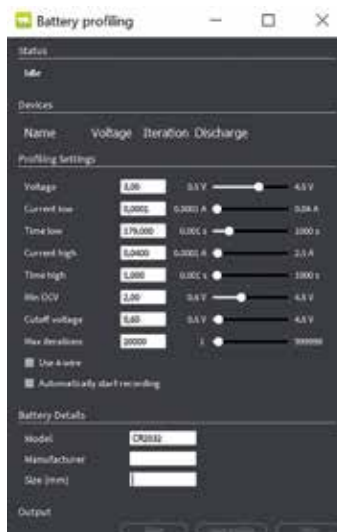
Impostazioni per la profilazione della batteria per una batteria a bottone CR2032
