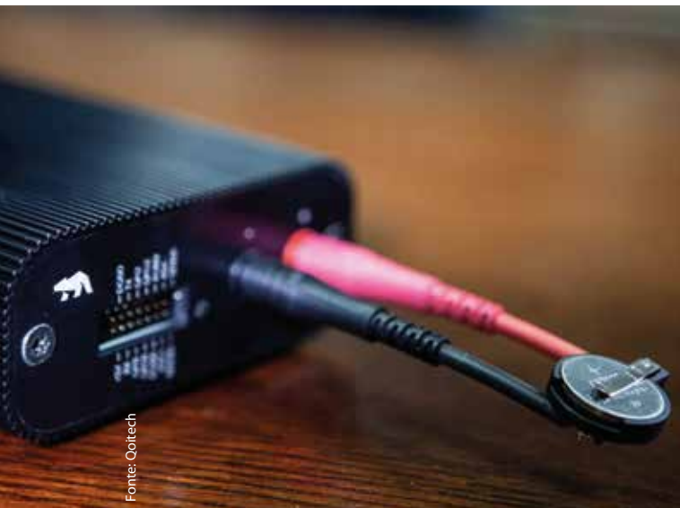
Una batteria CR2032 collegata a Otii Arc per la profilazione della batteria a bottone
