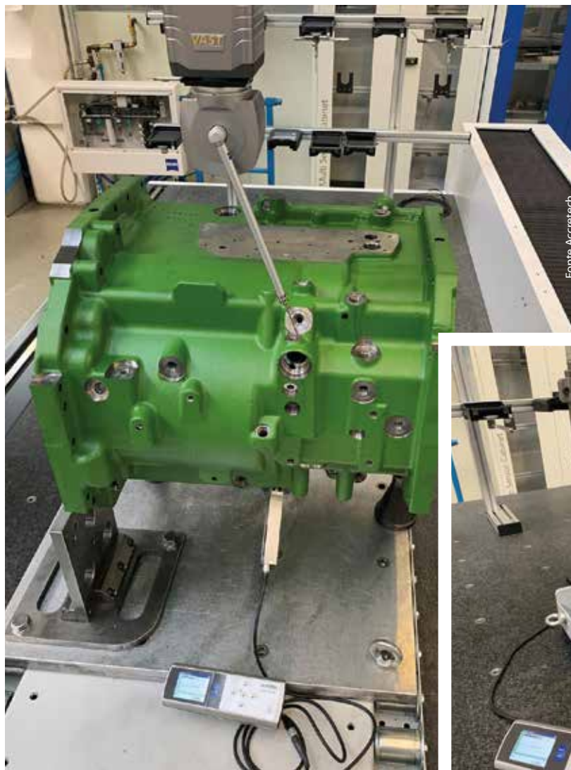
I valori di misura forniti da Handysurf+ confluiscono immediatamente nel rapporto di misurazione della macchina di misura a coordinate in Zeiss Calypso
