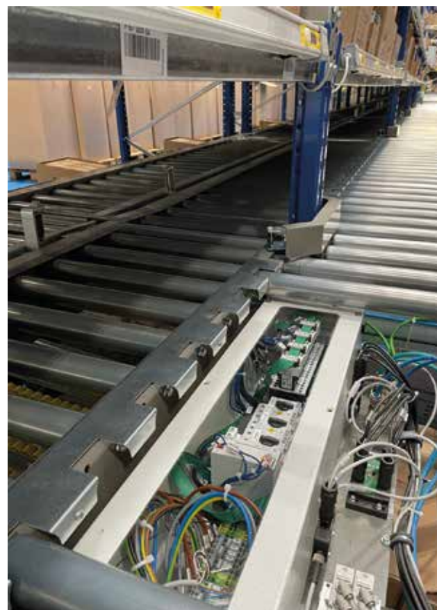
Movimentazione e immagazzinamento automatici dei colli è supportato dal sistema di cablaggio intelligente SmartWire-DT
