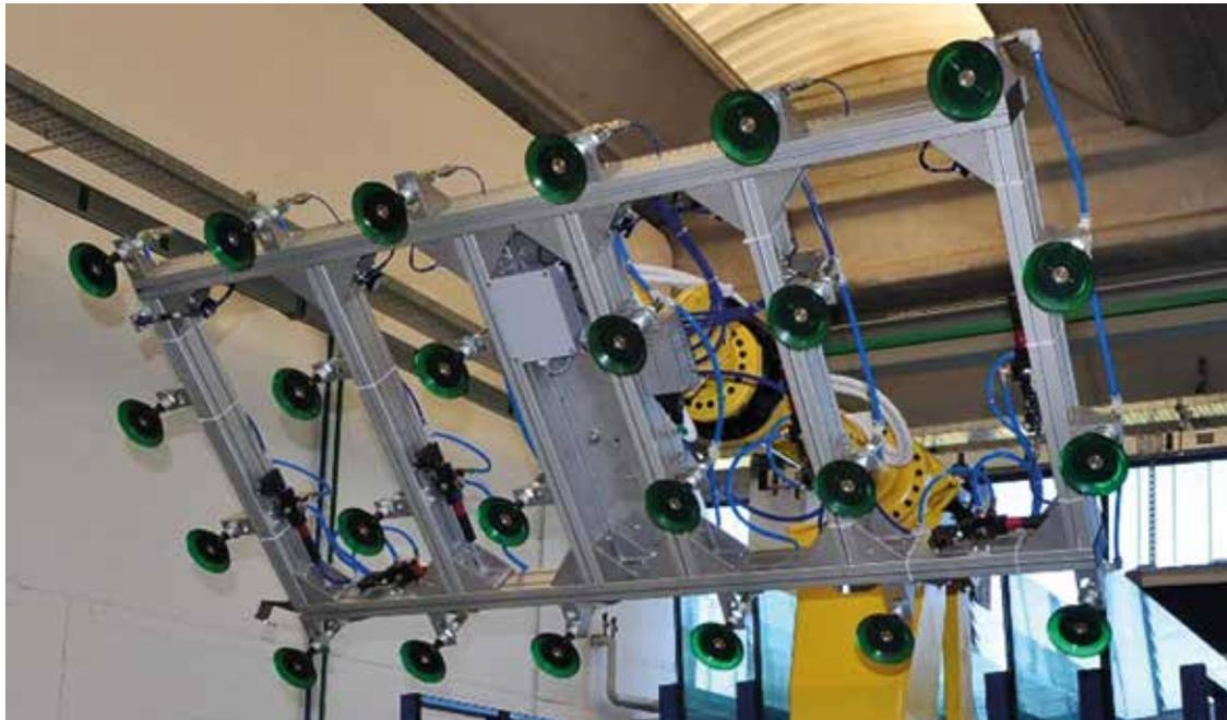
Le ventose Duraflex prelevano il vetro in posizione verticale da un cavalletto a bordo macchina e lo depositano in orizzontale sul banco di lavoro
