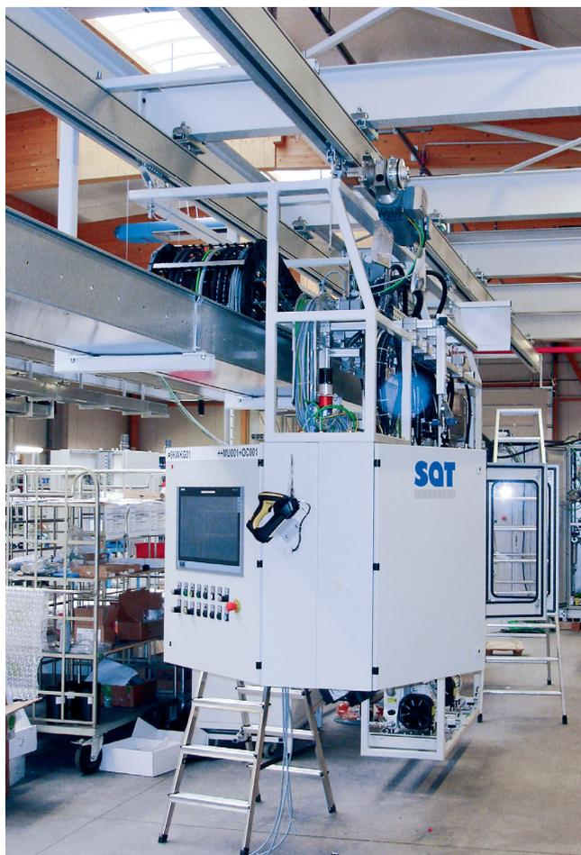
**Nei sistemi automatici di assemblaggio e filling medium di SAT Sterling vengono installati i sistemi portacavi Totaltrax di Kabelschlepp**
