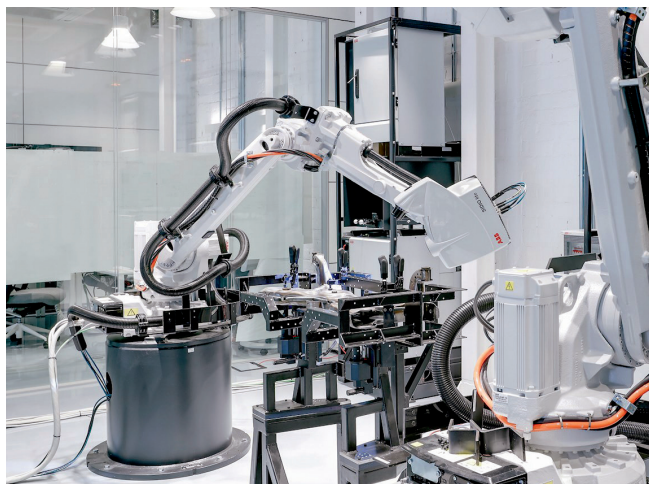
La cella è progettata per stazioni di collaudo fuori linea ed è modulare per consentire la personalizzazione
