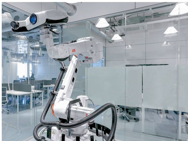
La cella 3DQI automatizza il processo di ispezione offrendo velocità, precisione e ripetibilità
