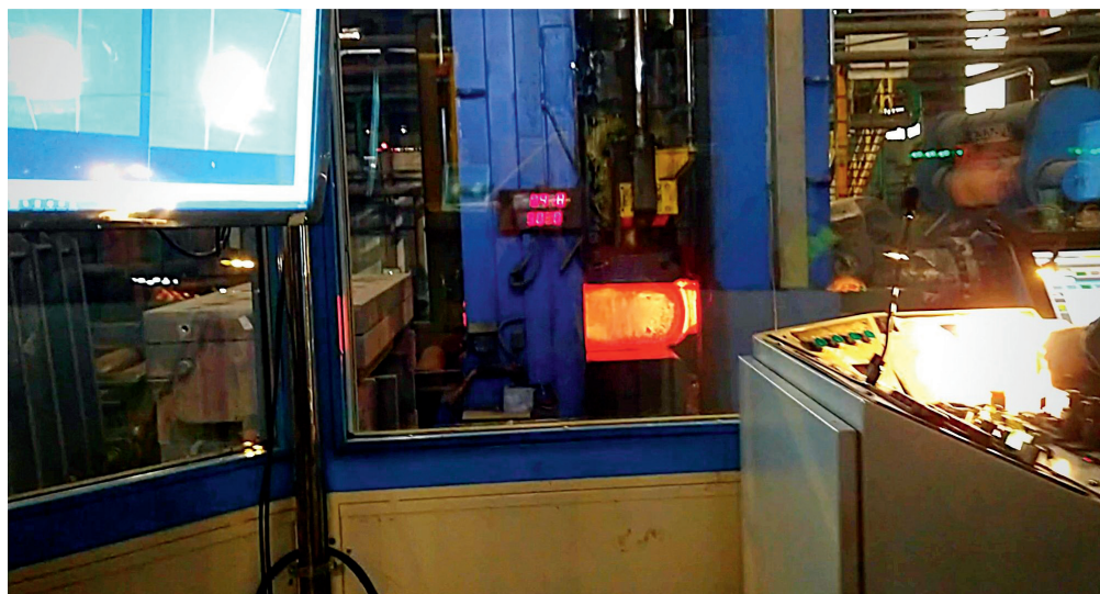
Il flusso video e i dati elaborati vengono distribuiti su una o più HMI poste sul pulpito e in altre zone di controllo
