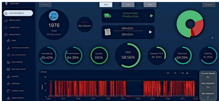
**La piattaforma di IMA è stata sviluppata con la tecnologia ThingWorx di PTC e permette di trasformare i dati grezzi raccolti dalle macchine in informazioni utili a migliorare l'efficienza dei processi**
