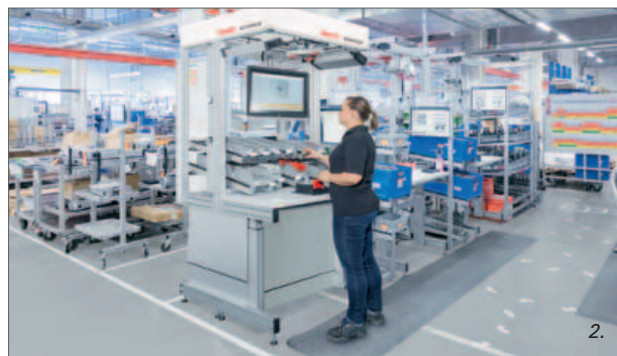
1. La macchina invia un messaggio di errore ai responsabili di linea e le relative informazioni per la soluzione dei problemi direttamente su smart device - 2. Assistente digitale per varie attività di assemblaggio, l'ActiveAssist è in grado di supportare i dipendenti con informazioni mirate e funzioni di guida garantendo processi di qualità grazie a un software
