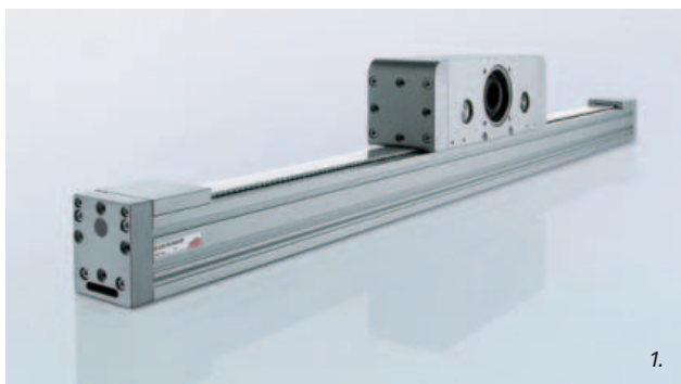
1. Grazie a uno specifico meccanismo (rinvio) a Omega, i nuovi assi Serie 5V sono in grado di muovere solo l'asse, mantenendo carro e motore fermi - 2. Alcune soluzioni della gamma C_Electrics
