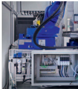
1. Da sinistra: Emiliano Berretta, disegnatore meccanico, Luca Geri, responsabile software, e Ilario Barsacchi, responsabile del progetto - 2. Festo Motion Terminal Vtem permette di cambiare rapidamente la funzionalità dell'utensile - 3. L'elettronica Festo, collegata al terminale di valvole, garantisce la qualità della lavorazione
