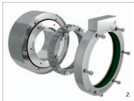
1. La serie di trasduttori rotativi induttivi EBI/ECI 4010 è stata completata dalla versione con albero cavo di 180 mm. Questo sistema di misura si integra perfettamente nelle macchine moderne grazie alle interfacce digitali EnDat e Drive-CLiQ - 2. I trasduttori rotativi induttivi ECI 4000/EBI 4000 trovano impiego su motori altamente dinamici, moduli di azionamento e componenti di macchine che richiedono un corrispondente albero cavo nel sistema di misura
