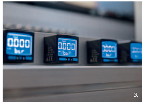
1. Da sinistra: Emiliano Berretta, disegnatore meccanico, Luca Geri, responsabile software, e Ilario Barsacchi, responsabile del progetto - 2. Festo Motion Terminal Vtem permette di cambiare rapidamente la funzionalità dell'utensile - 3. L'elettronica Festo, collegata al terminale di valvole, garantisce la qualità della lavorazione
