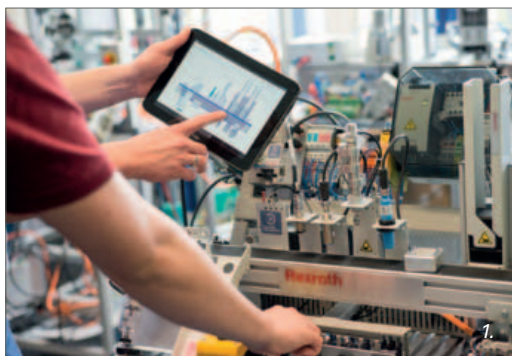
1. La macchina invia un messaggio di errore ai responsabili di linea e le relative informazioni per la soluzione dei problemi direttamente su smart device - 2. Assistente digitale per varie attività di assemblaggio, l'ActiveAssist è in grado di supportare i dipendenti con informazioni mirate e funzioni di guida garantendo processi di qualità grazie a un software
