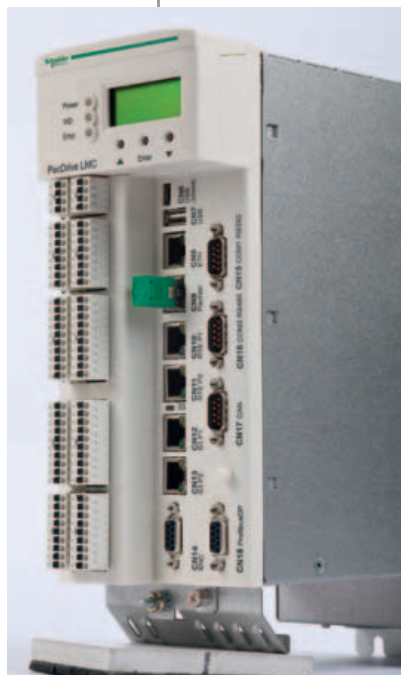
PacDrive 4.3: con LMC 800 Pro2 possibile sincronizzazione fino a 130 servo assi
