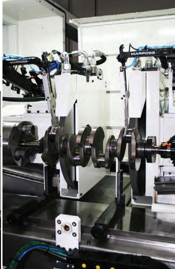
AZ realizza soluzioni per la rettificazione di alberi a gomito e costruisce macchine manuali per il rebuilding.
