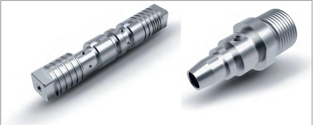
Stantuffo di comando (diametro 20 x 160 mm) del settore idraulico: il materiale è acciaio (CK45) e il tempo di lavorazione 260 s.
