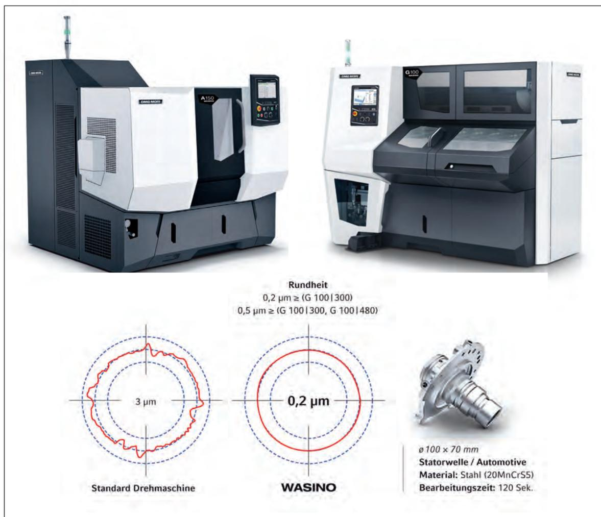
Alla EMO di Milano, DMG Mori ha presentato i due torni ad altissima precisione A 150Y18 e G 100480, ideali per le linee di produzione. Wasino è sinonimo di torni di altissima precisione per linee di produzione nel settore automobilistico con valori di rotondità fino a 0,2 µm.
