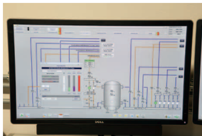
IO-Link consente l'accesso a ogni singolo sensore dal PC
