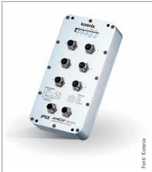
Figura 3 - Due esempi di switch appositamente sviluppati per soddisfare le esigenze di robustezza e ingombro in applicazioni industriali e aeronautiche
