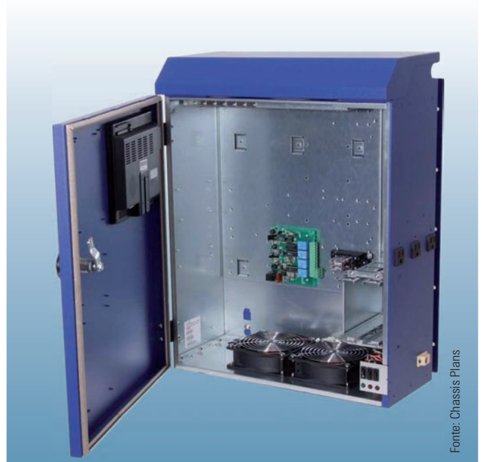
Figura 7 - Involucri con protezione di grado industriale rendono possibile utilizzare apparecchi destinati al settore consumer nell'ambiente ostile della fabbrica
