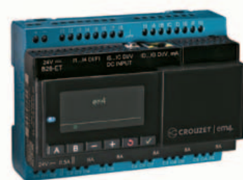
I controllori logici em4 con nano-PLC sono dotati di 26 I/O compresi accurati ingressi analogici per sensori 0-20 o 4-20 mA, uscite statiche PWM e a relè
