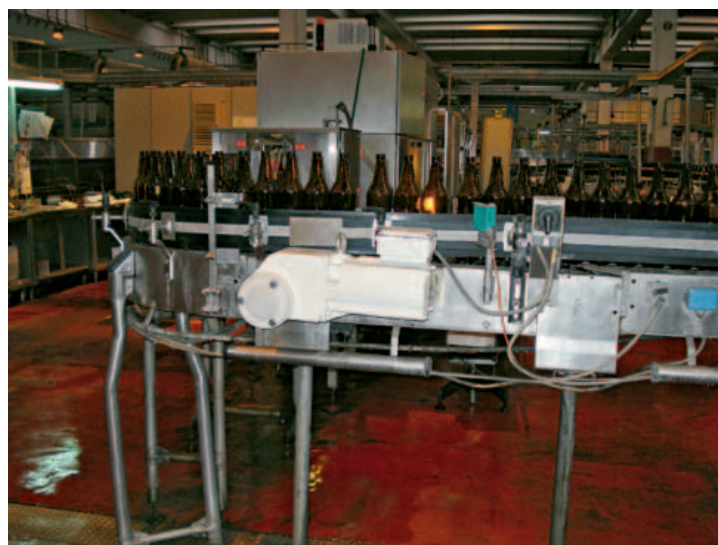
Il motore a magneti permanenti che compone il motoriduttore Danfoss VLT OneGearDrive ha una efficienza pari al 96%, che eccede l'attuale normativa e molto probabilmente sarà in grado di soddisfare anche gli sviluppi legislativi prevedibili nel prossimo decennio
