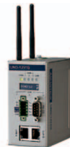
Uno-1251G è piccolo come un micro PLC e montabile su guida Din
