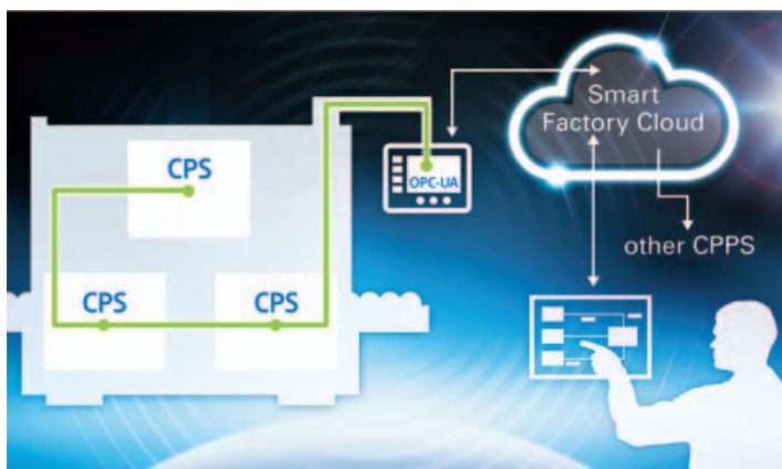
Figura 3 - I sistemi di produzione possono comunicare con il sistema di controllo della fabbrica grazie a protocolli standard come OPC-UA
