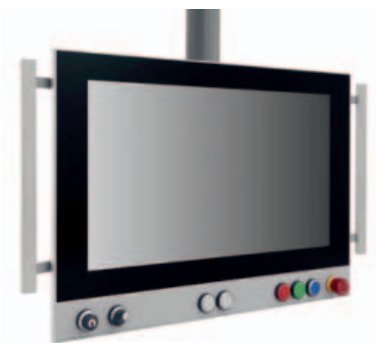
I sistemi VK3200 sono basati sulla piattaforma x86 Intel Broadwell ULT con processori Core i3, i5 e i7 Ultra Low Voltage di quinta generazione
