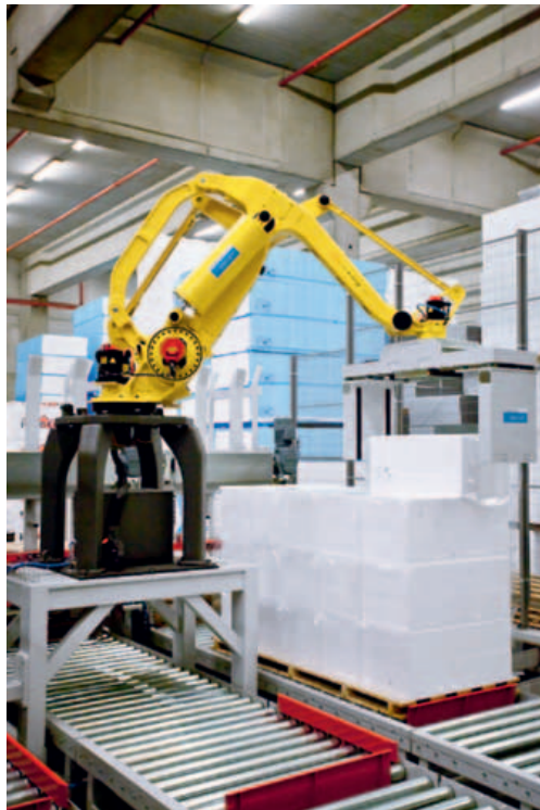
I pannelli imballati vengono impilati da un robot in base allo schema del pallet appropriato
