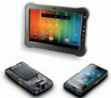
Tra le prove a cui i rugged sono sottoposti si ricordano il funzionamento in bassa pressione per simulare l'utilizzo alle alte quote, l'esposizione a temperature alte e basse anche con variazioni repentine
