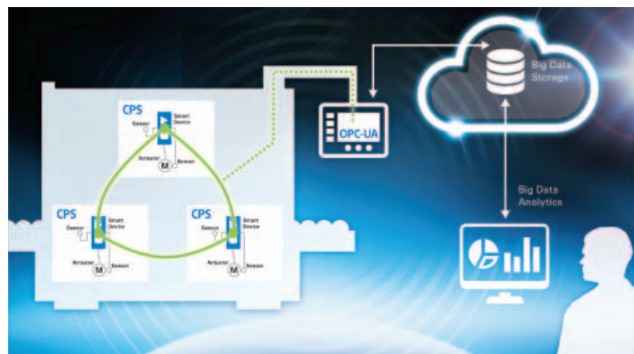
Figura 5 - Quando un CPS è in grado di comunicare con altri sistemi simili è possibile avere dei sistemi di produzione ciberfisici indipendenti (CPPS)
