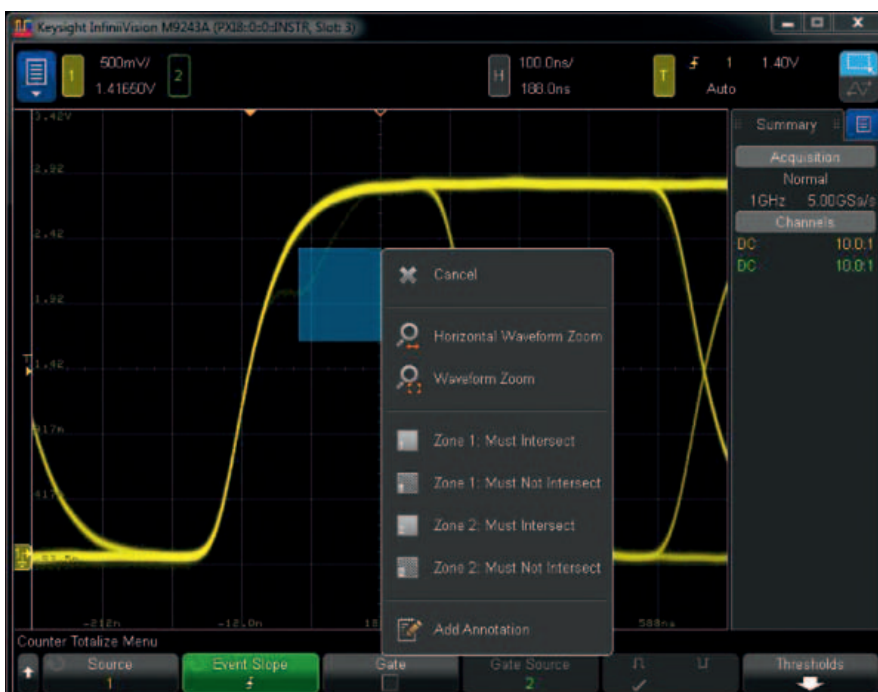
Figura 3 - Isolare un segnale con un bordo non monotono è semplice come disegnare un riquadro sul segnale di interesse e selezionare 'Must Intersect'
