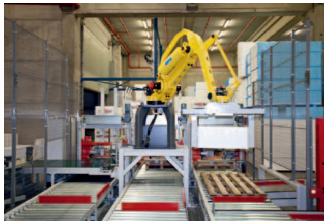
Un robot di Fanuc nella linea automatizzata per il packaging dei pannelli
