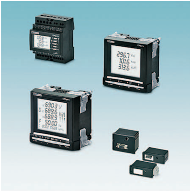
Il modello EEM-MA400 è un misuratore di energia universale che può essere installato nella porta del quadro elettrico o fissato in montaggio frontale ed è espandibile con un modulo di comunicazione RS485 (RTU Modbus)
