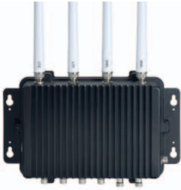
L'EBOX800-841FL dispone di CPU on-board quad-core Intel Atom E3845 (Bay Trail), supporta fino a 8 GB di Ram e diverse possibilità di storage
