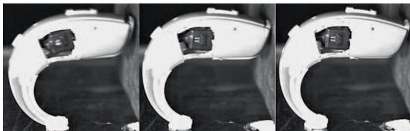
Figura 4 - Video ad alta velocità per registrare l'impatto. La foto a sinistra è stata scattata 0,9 millisecondi dopo l'impatto, quella al centro 0,1 millisecondi dopo, quella a destra esattamente al momento dell'impatto. Osservate lo spostamento del ricevitore al centro del dispositivo
