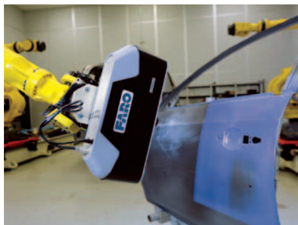
Cobalt 3D Imager montato su un robot per acquisire la forma di una portiera
