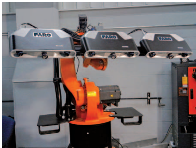
Tre dispositivi Cobalt 3D Imager di CAM2 montati in configurazione array su un robot
