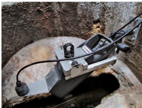
Il Raven-Eye Flow-Tronic è un sensore di portata radar adatto ad applicazioni in canali aperti
