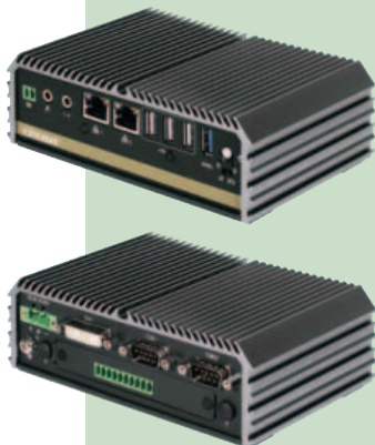
Il fronte e il retro del PC fanless DA-1000 serie Diamond Affordable di Conradata
