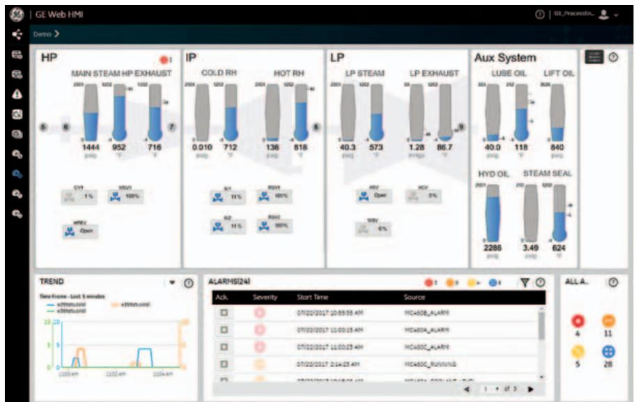
iFIX 5.9 è un vero e proprio **HMI nativo per il web**. I Web client non richiedono alcuna installazione lato client. La configurazione, lo sviluppo e la distribuzione sono tutti centralizzati e qualsiasi aggiornamento o modifica impostata sul server vengono automaticamente riportati sui client. I client possono essere avviati tramite una sessione da browser o terminale e riportano sempre gli ultimi aggiornamenti software installati sul server. ■
