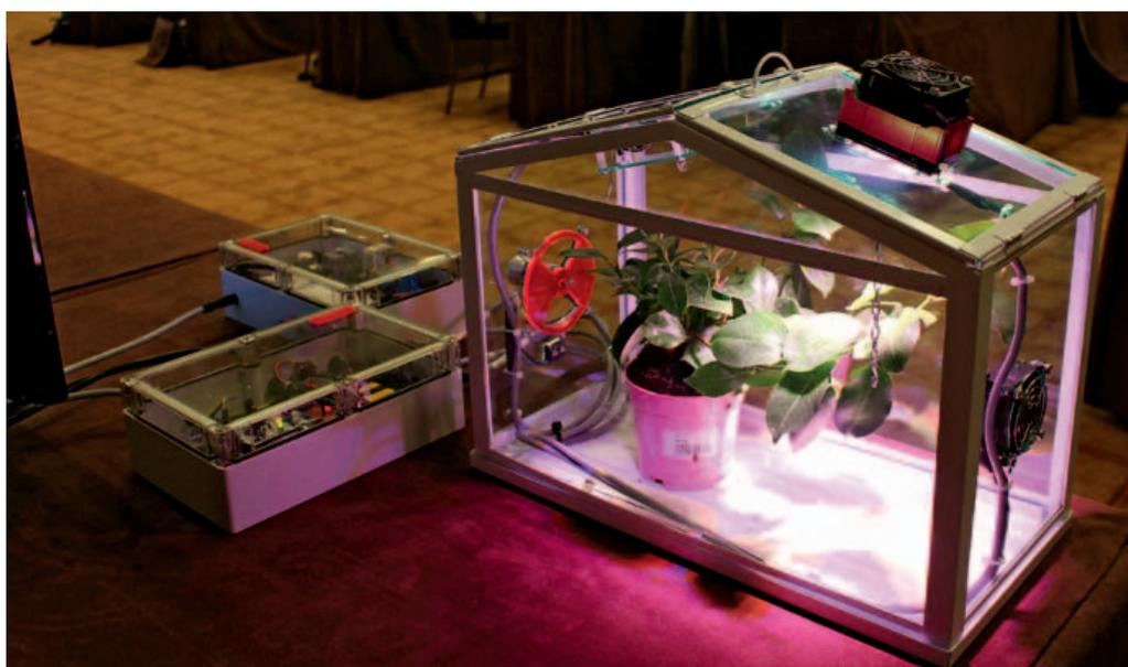
*L'utilizzo di sistemi led in orticoltura consente di gestire con precisione l'illuminazione delle piante e rende l'agricoltura in serra più controllabile e simile a un processo industriale*
