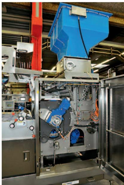
*Vista interna della macchina di ripartizione e conformazione Industrie Rex AW-H, che mostra il motore a ingranaggi e l'azionamento principale (Fonte: WEG)*
