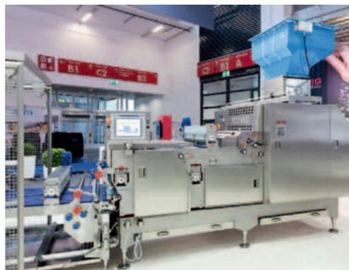
*Macchina di ripartizione e conformazione Industrie Rex AW-H con nastro di uscita disaccoppiabile (Fonte: Koenig)*
