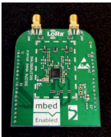
*Un kit di sviluppo Semtech per la tecnologia LoRaWAN*
