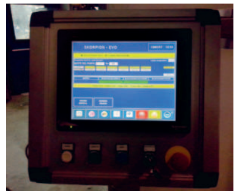
Interfaccia operatore HMI GTU e Pulsanti Schneider Electric
