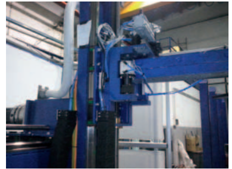
Dettaglio dell'asse Z per la parte di apertura laterale della morsa (pneumatica) e suo blocco
