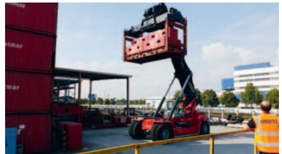
I dati sulla deformazione dell’acciaio hanno permesso il calcolo della fatica a cui è sottoposta la struttura del mezzo
