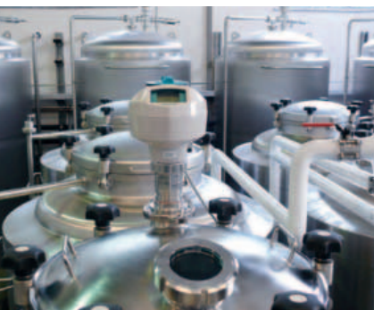
Il trasmettitore di livello radar Siemens Sitrans LR250 è progettato per l'impiego in presenza di sostanze corrosive
