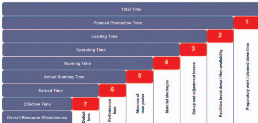
^ Le fermate impreviste influiscono negativamente sull'OEE (Overall Equipment Effectiveness) sottraendo dalla disponibilità totale una parte consistente della produttività prevista di un impianto. Fonte RNA Automation
